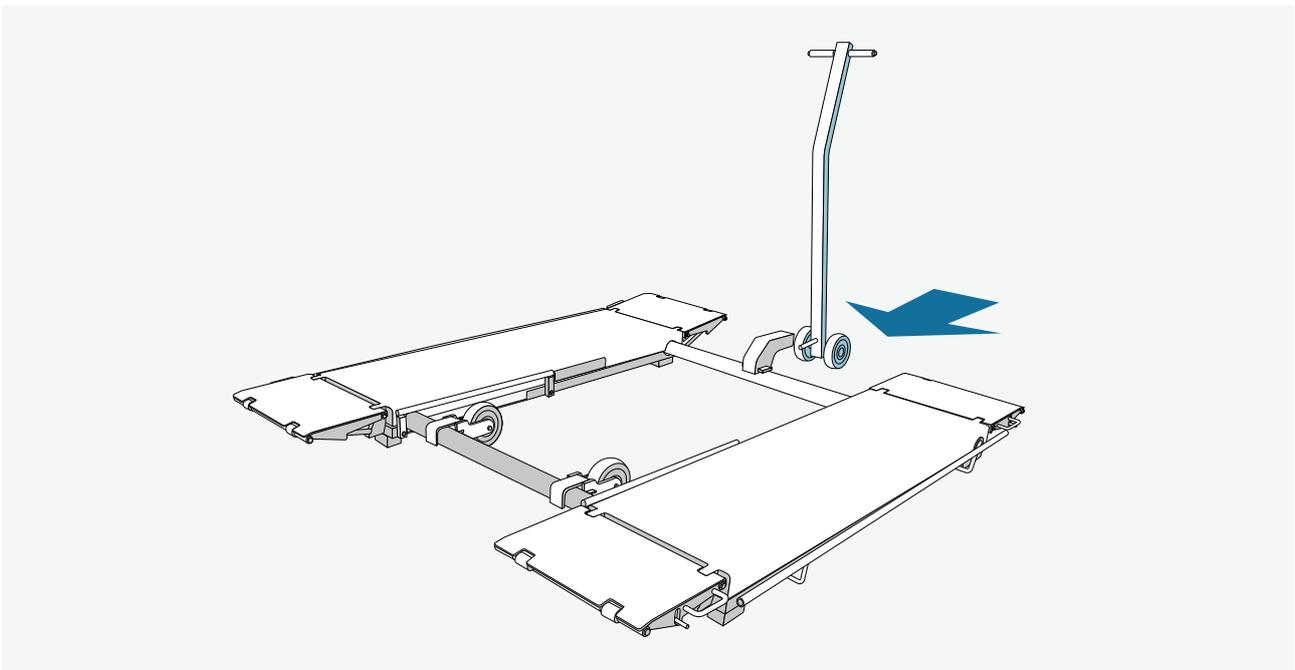
Kippsattel/Transportachse (c) einsetzen. Fahrdeichsel an Kippsattel ansetzen.
