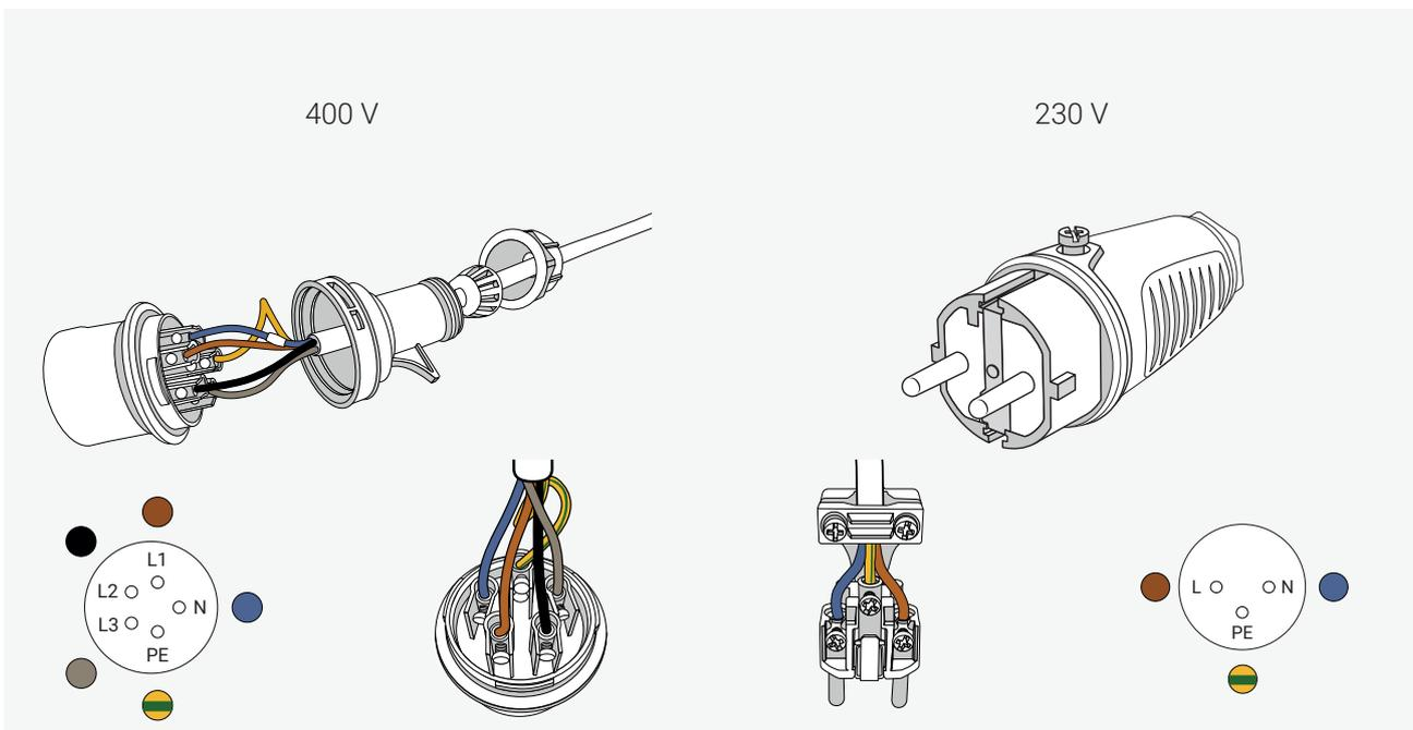
CEE Stecker (f) je nach Bedienpult anschließen.
