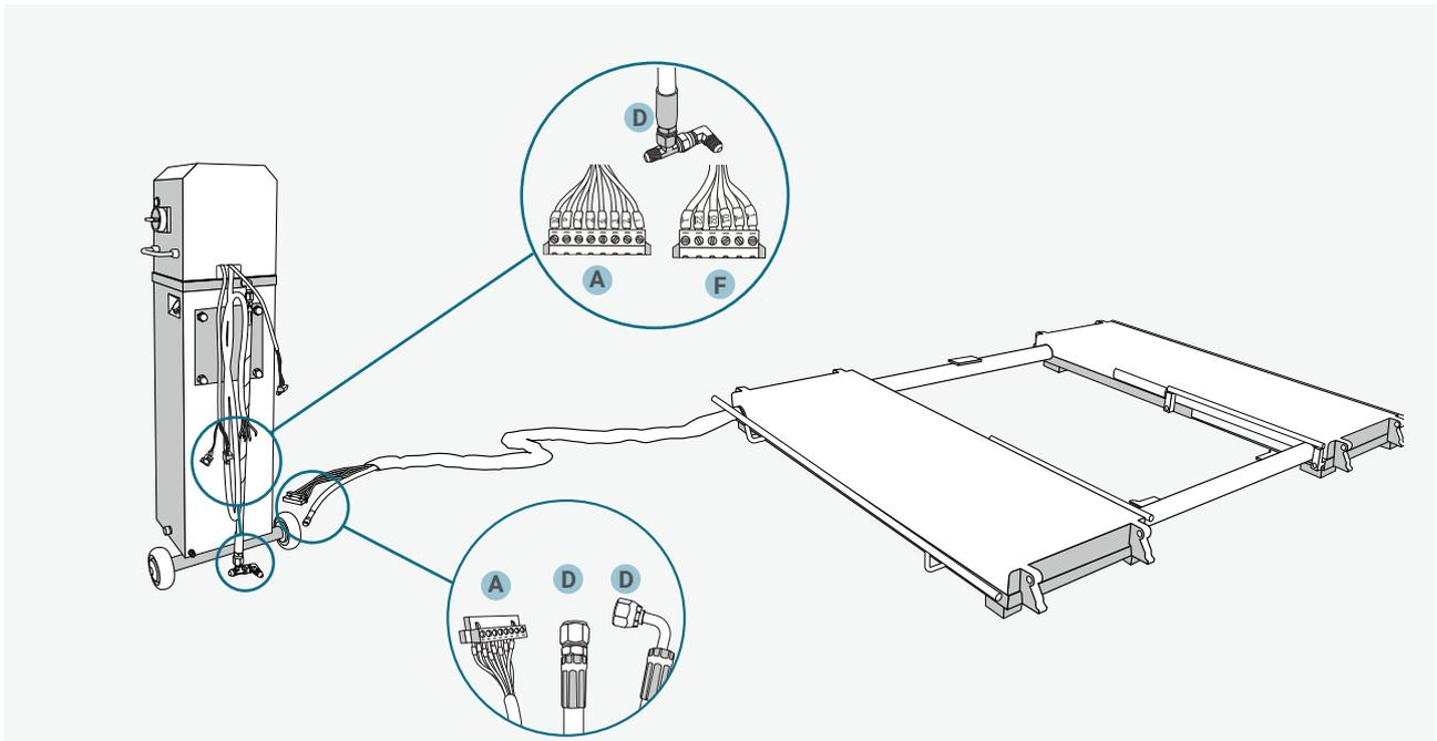
Anschluss (A) mit beiden Befestigungsschrauben für Stecker zusammenstecken. Hydraulikschläuche (D) anschließen und festziehen. Stecker (F) ist für die optionale Fernbedienung.
