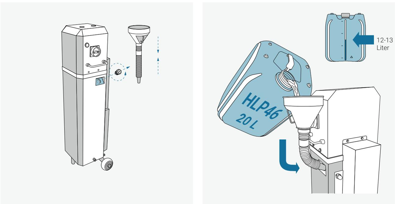
Trichter und Verlängerung (i) zusammenstecken. Danach den roten Öltankdeckel am Bedienpult entgegenge-
