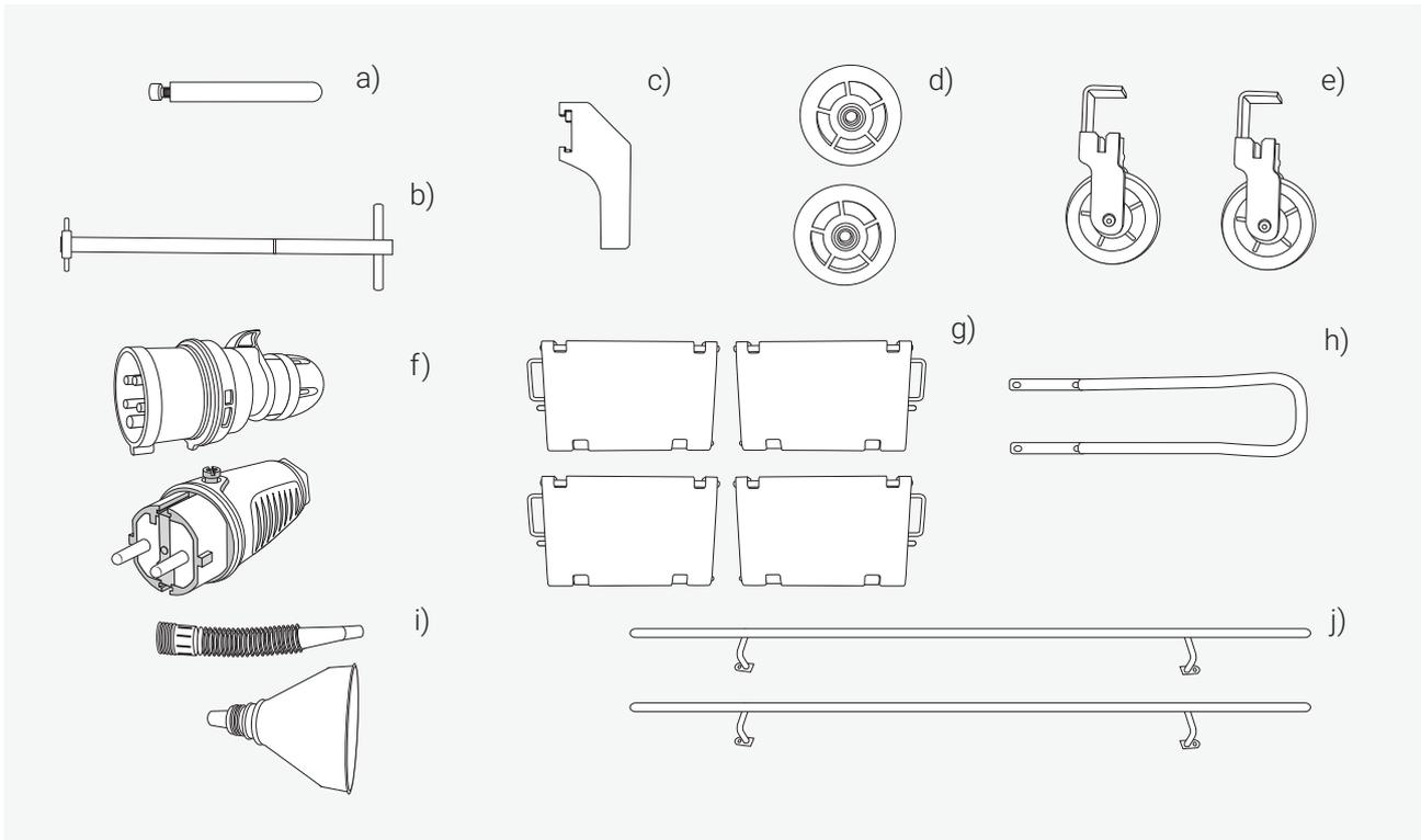
a) Arretierungsbolzen b) Fahrdeichsel c) Kipp-Hebel (Transportachse) d) Laufrollen e) Laufrollen mit Halterung
