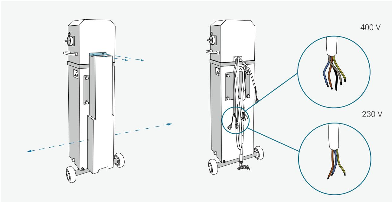
Den Kabelschutz am Bedienpult entfernen (4 Schrauben).
