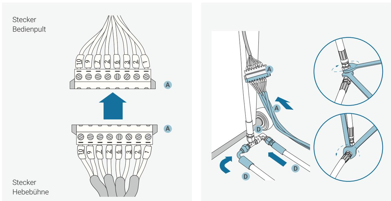
Nach dem Zusammenführen der Hydraulikschläuche und der Elektrokabel, müssen nochmals alle Schraubverbindungen nach korrektem Sitz, Festigkeit und Dichtigkeit überprüft werden.
