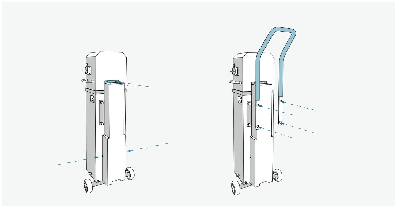
Kabelabdeckung mit 4 Kreuzschrauben anbringen und den Führungsgriff (h) mit 4 Hutschrauben befestigen.
