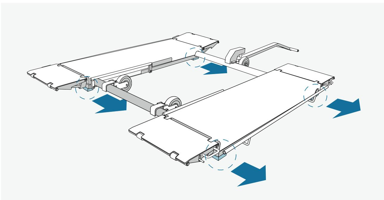
8 Holzblöcke an den beiden Bodenplatten entfernen.
