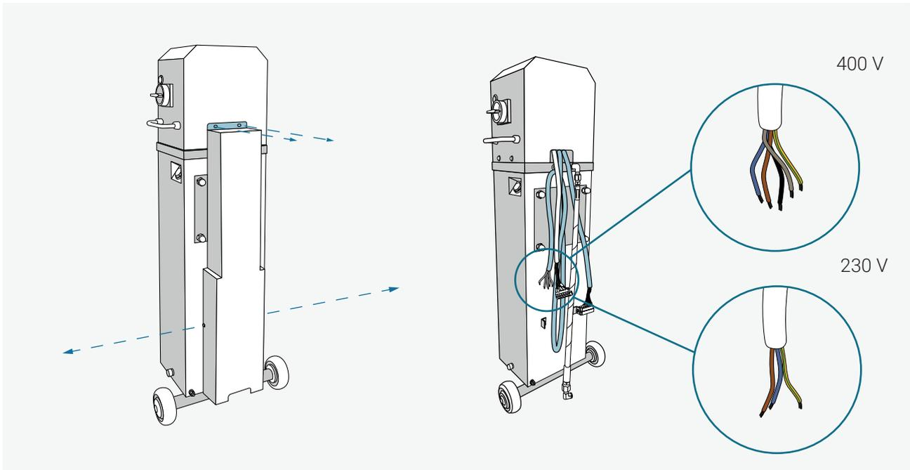
Den Kabelschutz am Bedienpult entfernen (4 Schrauben).
