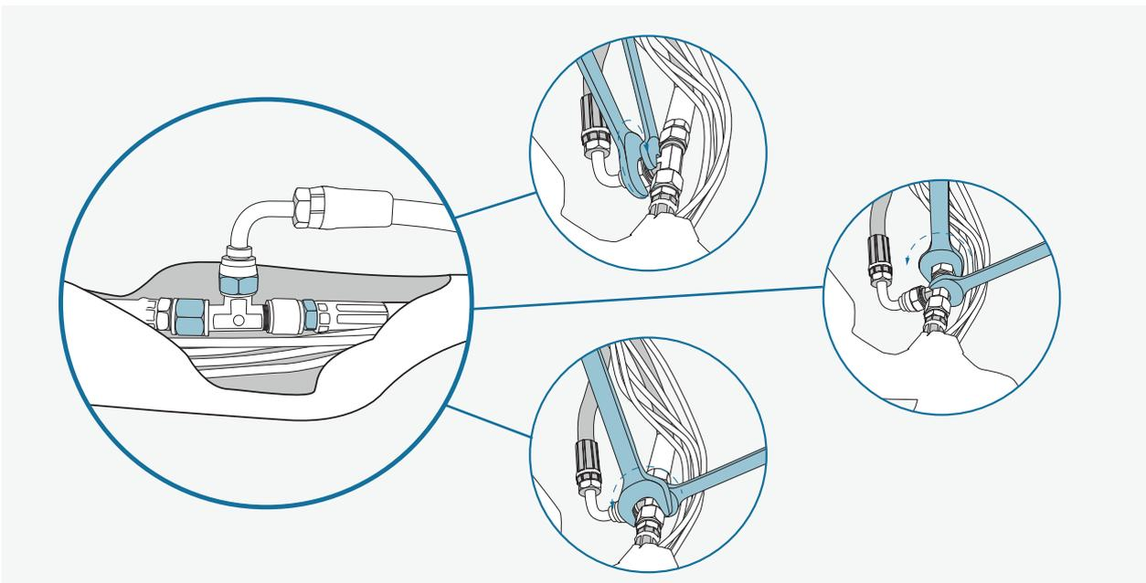
T-Stück mit 14er-Maulschlüssel festhalten und Verbindungsschraube mit 19er-Schlüssel festziehen.
