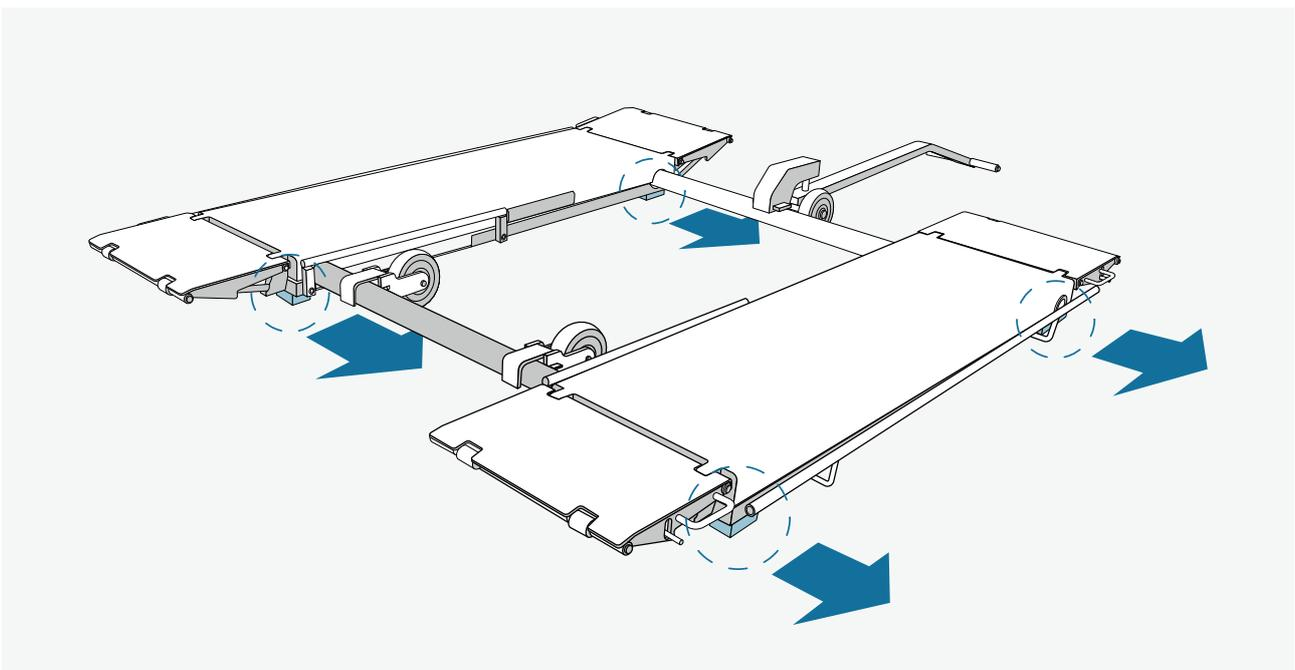
8 Holzblöcke an den beiden Bodenplatten entfernen.
