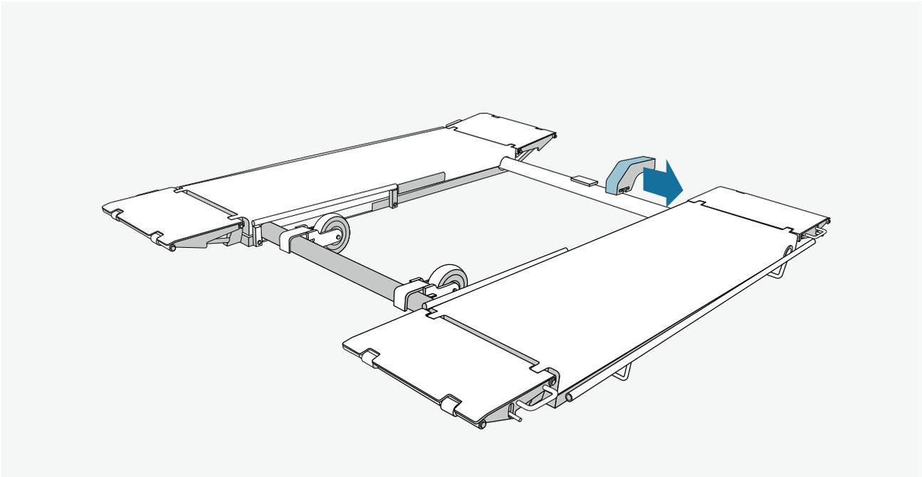
Hebebühne muss bei der Entfernung in Null-Position sein. Tipp: Falls der Kipp-Hebel/Transportachse (c) sich schwierig entfernen lässt, kann vorsichtig mit einem Hammer nachgeholfen werden.
