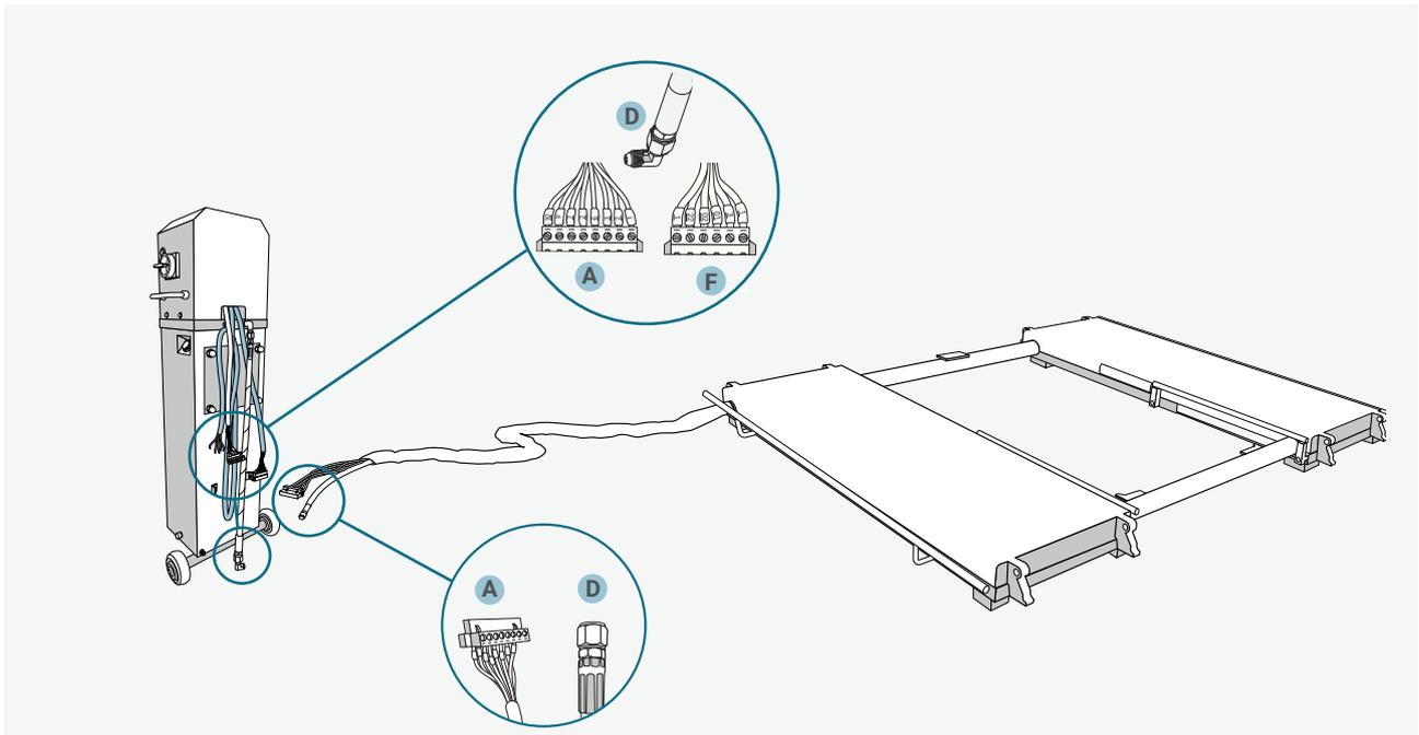
Anschluss (A) mit beiden Befestigungsschrauben für Stecker zusammenstecken. Hydraulikschlauch (D) anschließen und festziehen. Stecker (F) ist für die optionale Fernbedienung.
