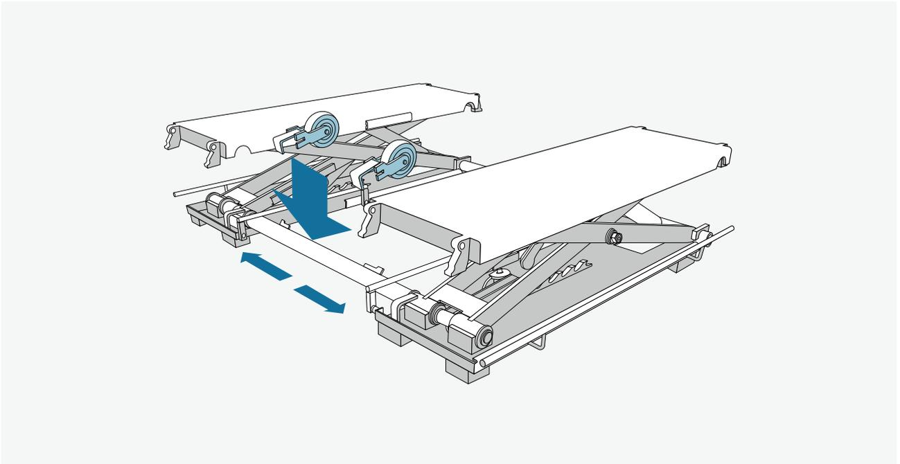
Die Laufrollen mit Halterung (g) werden mittig an der vorderen Querstange der Hebebühne angesetzt.
