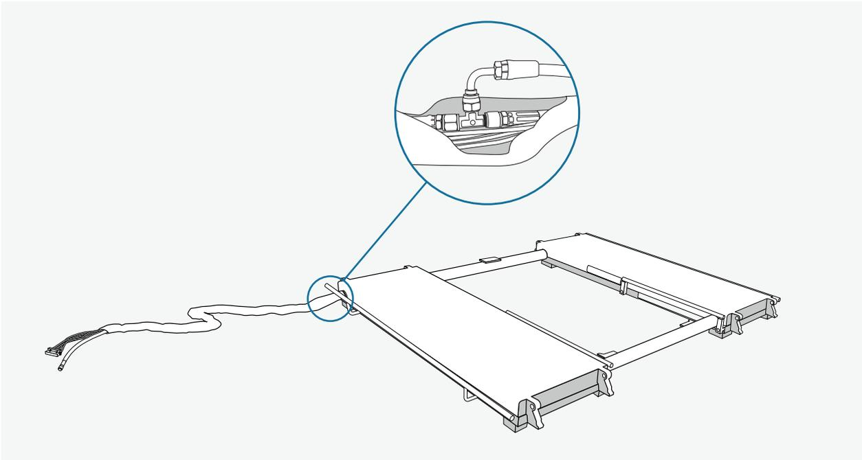
Hydraulikanschlüsse festziehen und anschließend auf Dichtigkeit überprüfen.
