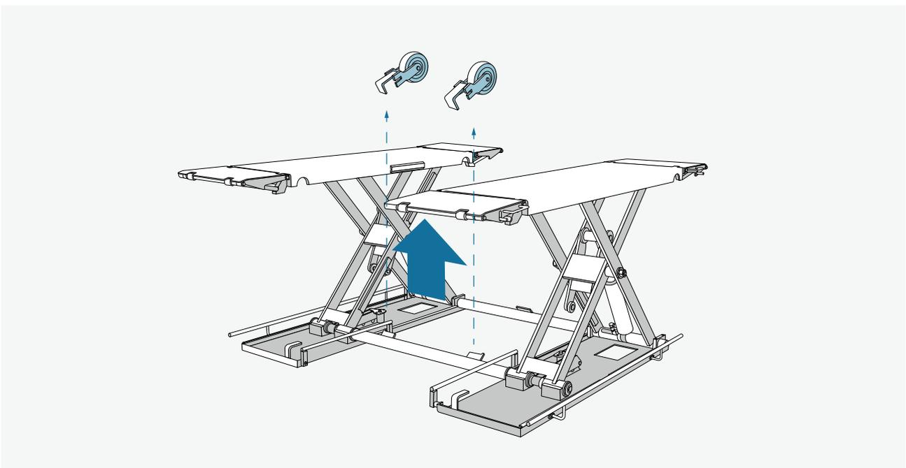
Um die Laufrollen mit Halterung (e) abzumontieren muss die Hebebühne nach oben gefahren werden.
