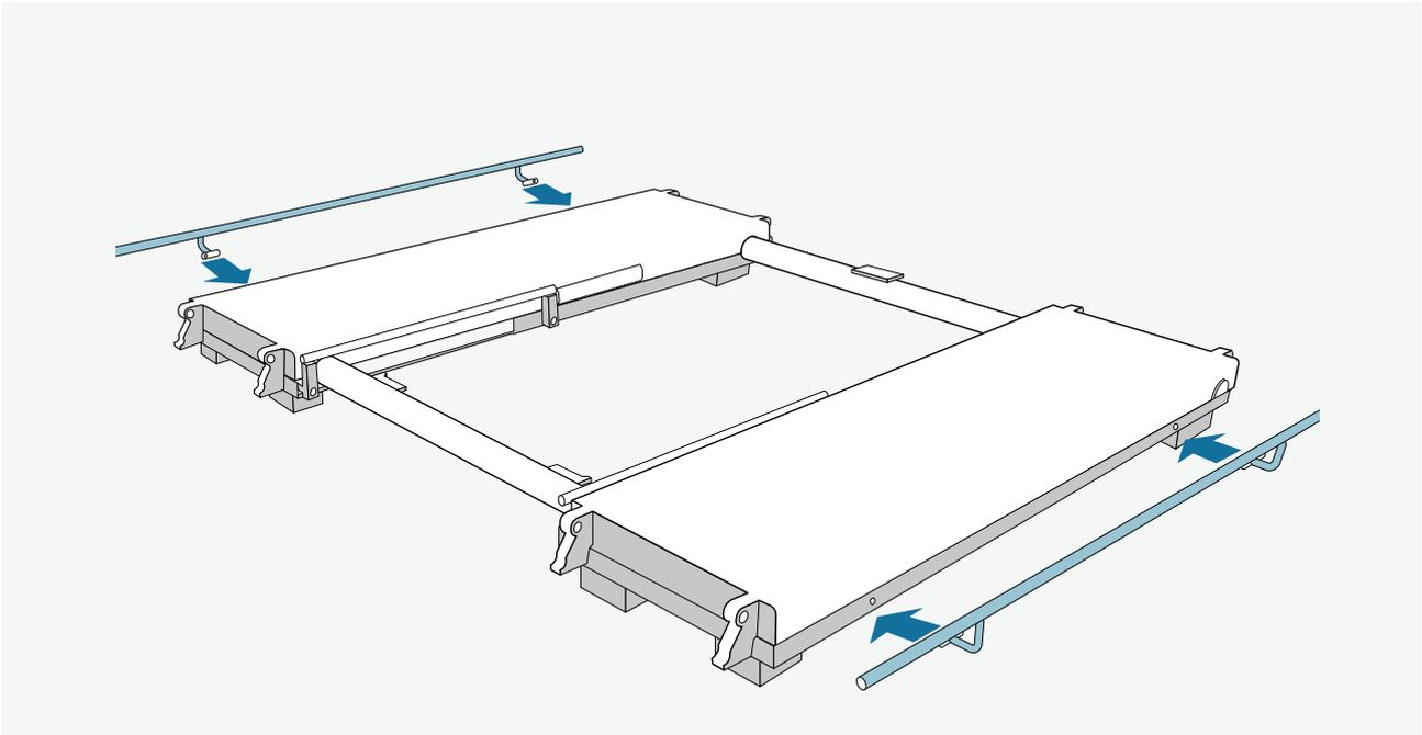
Die Fußschutzstangen (j) werden mit dem Haltebogen nach oben an die Bodenplatte verschraubt. Hierzu müssen die zwei Imbusschrauben von der Außenkante der Bodenplatte vorab entfernt werden.
