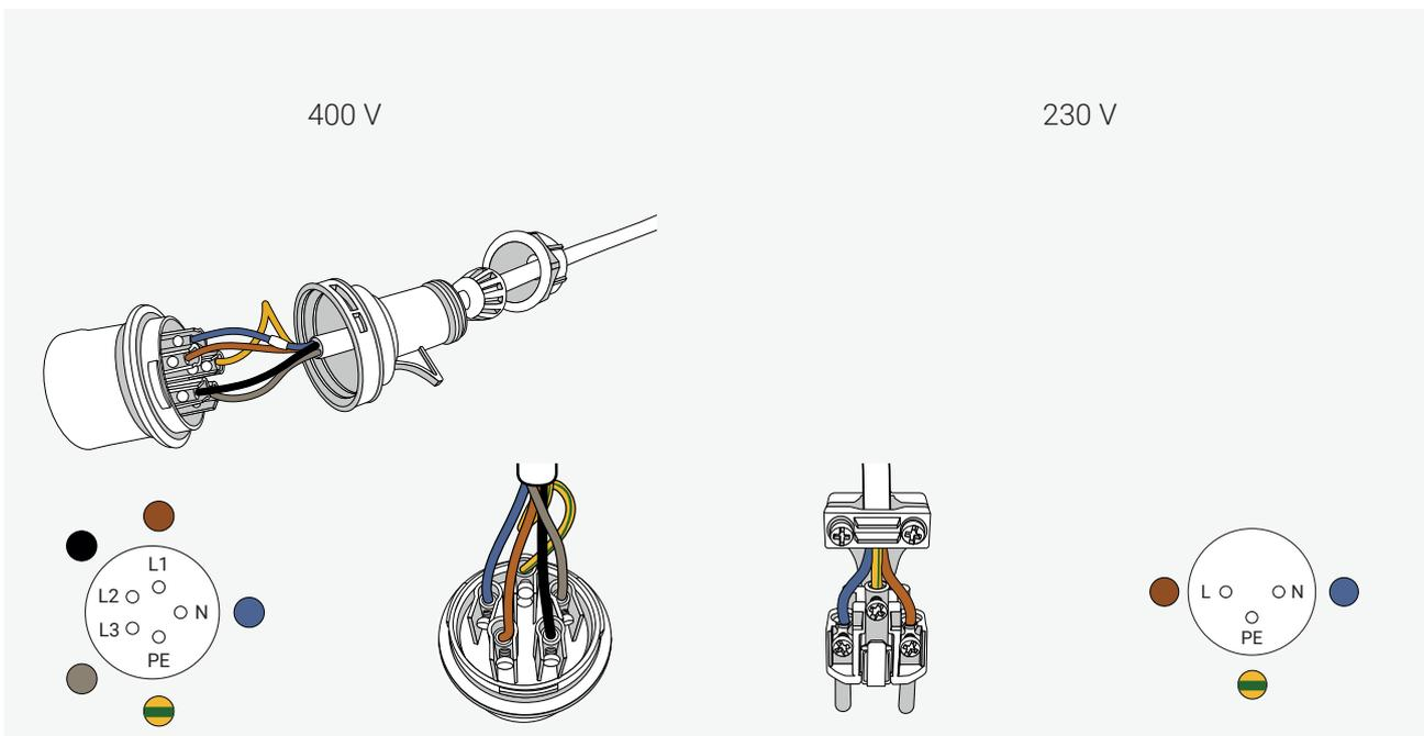
CEE Stecker (f) je nach Bedienpult anschließen.
