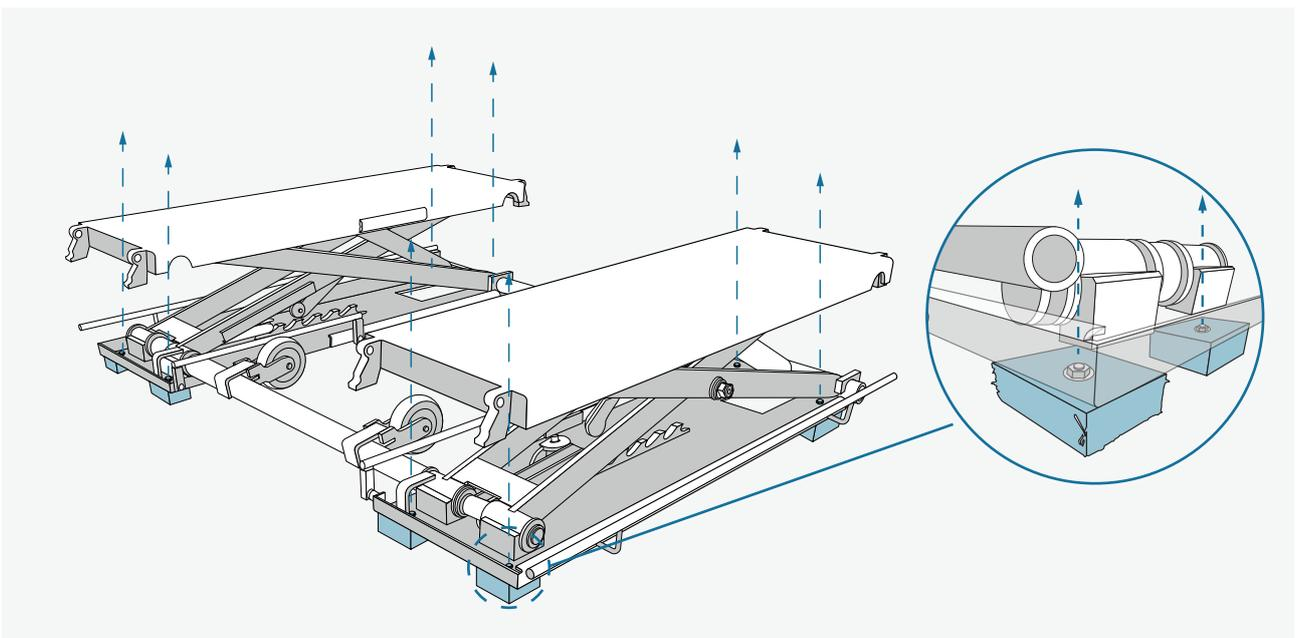
Plattformen nach oben fahren bis Hebebühne einrastet. Schrauben der 8 Holzblöcke entfernen.
