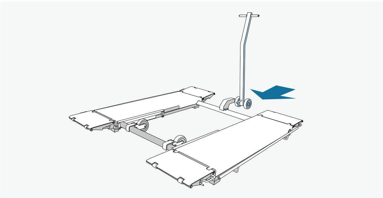
Kippsattel/Transportachse (c) einsetzen. Fahrdeichsel an Kippsattel ansetzen.
