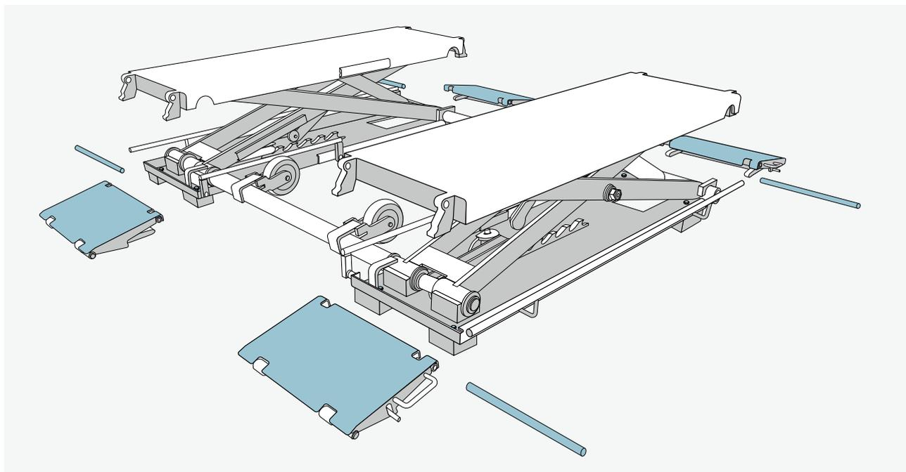
Vier Auffahrampen (e) an den oberen Plattformen mit den Halteachsen befestigen und rechts und links mit Seegeringen sichern.
