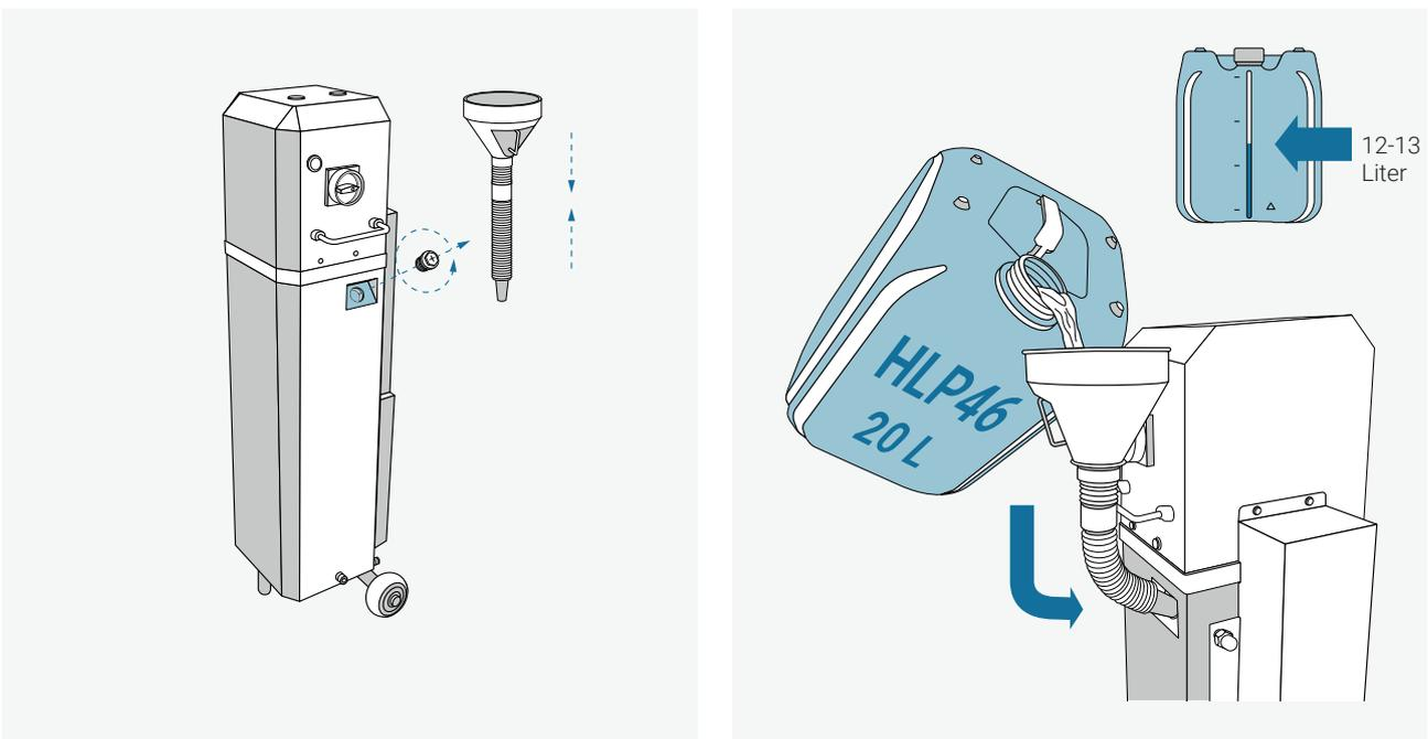
Trichter und Verlängerung (i) zusammenstecken. Danach den roten Öltankdeckel am Bedienpult entgegenge-setzt des Uhrzeigersinns aufdrehen. Die Verlängerung ansetzen und 12-13 Liter Hydrauliköl einfüllen.
