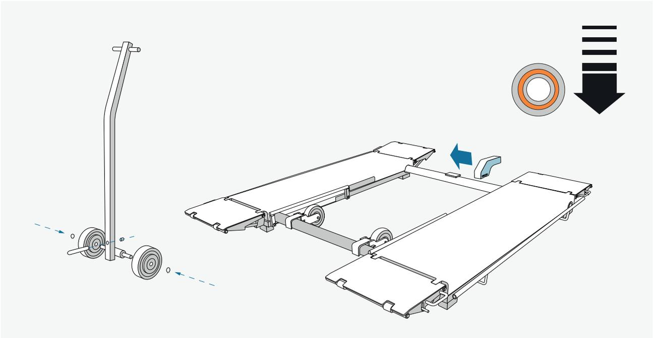
Arretierbolzen (a) befestigen. Laufrollen (d) an Fahrdeichsel anbringen und mit Seegeringen sichern.
