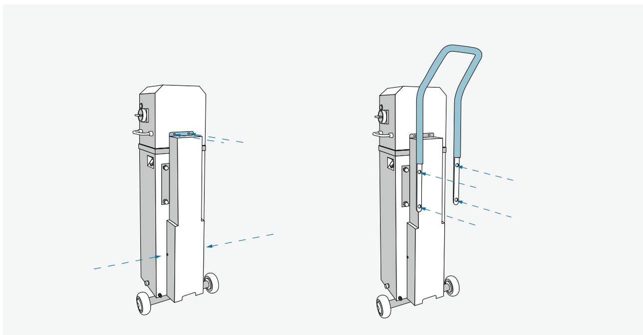
Kabelabdeckung mit 4 Kreuzschrauben anbringen und den Führunggriff (h) mit 4 Hutschrauben befestigen.
