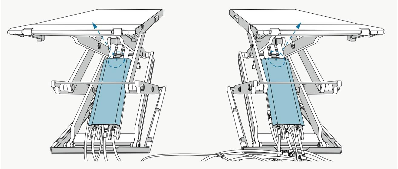
Lösen sie die Schraube des Abdeckbleches an beiden Plattformen und nehmen sie dasselbe ab um die Zylinder und Sicherheitsraste freizulegen.
