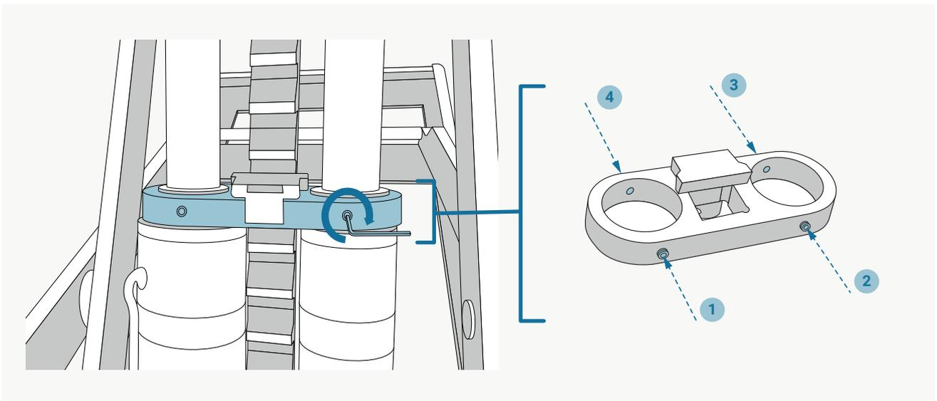
Ziehen Sie an beiden Plattformen an den Zylindern sowohl vorn als auch hinten 2 Schrauben mit einem Imbusschlüssel fest um das Verbindungsstück wieder zu fixieren (4 Schrauben pro Plattform). Anschließend muss das Abdeckblech wieder angebracht werden.
