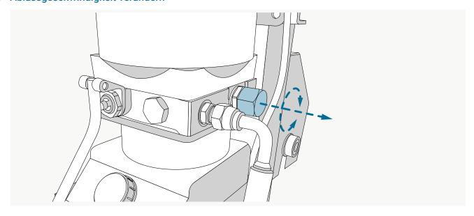
Um die Ablassgeschwindigkeit zu verändern, muss das Ablassventil geöffnet oder geschlossen werden. Um die Bühne schneller zum Ablass zu bringen muss das Ventil aufgedreht werden.
