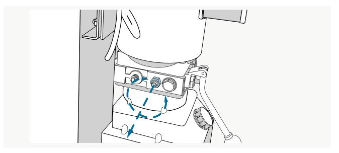
Um die Hubkraft zu verändern, öffnen oder schließen Sie das Hubkraftventil am Motor. Zudrehen = mehr Druck = mehr Hubkraft. Beim Öffnen wird Druck aus dem System genommen und die Bühne würde mit weniger Hubkraft heben.
