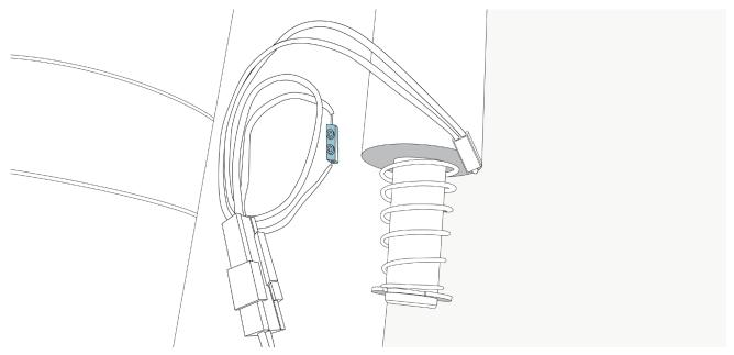
Die Kabelenden, mit Hilfe einer Lüsterklemme, wieder verbinden.
