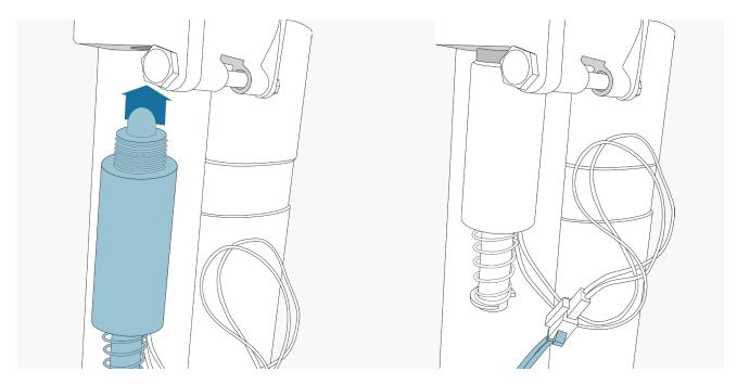
Abschließend wird der neue Elektromagnet in die Halterung geschraubt und die Steckerverbindung wieder hergestellt.
