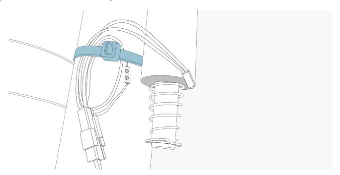
Abschließend wird das so eingekürzte Kabel mit einem Kabelbinder wieder befestigt.
