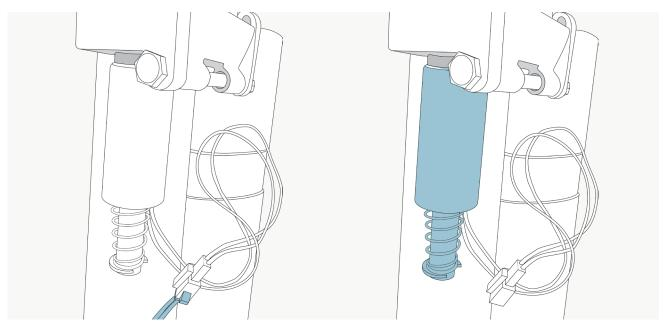
Lösen Sie zuerst den Stecker der Kabelverbindung, anschließend wird der Elektromagnet aus der Halterung geschraubt.
