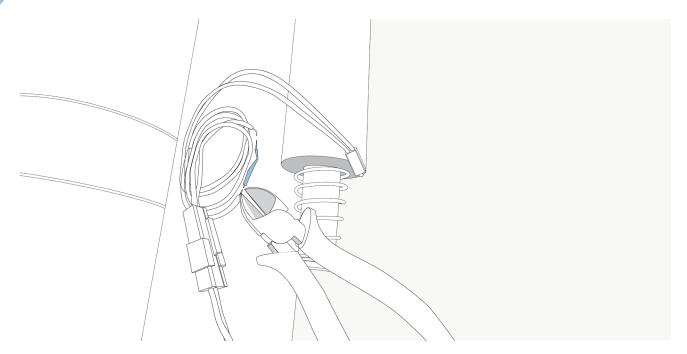
Wenn die schadhafte Stelle lokalisiert ist Kürzen Sie das Kabel links und rechst von Dieser um ca 2 cm.
