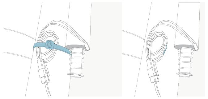
Entfernen Sie den zu engen Kabelbinder um den schadhaften Kabelteil zu lokalisieren.
