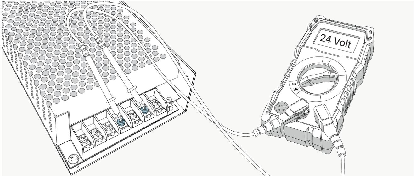
Bevor eine Spannungserhöhung vorgenommen wird sollte geprüft werden, ob wirklich die angegebene Stärke von 24 Volt am Steuergerät eintrifft.
