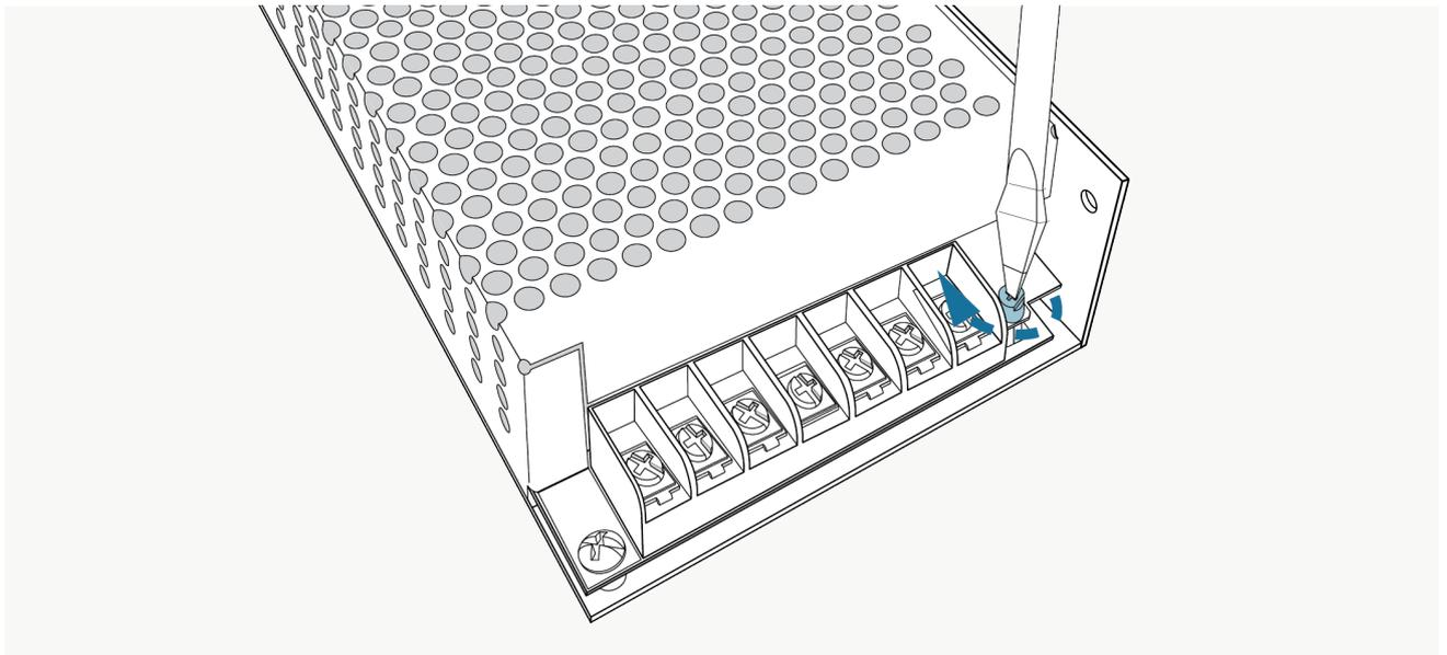
Anschließend kann, durch eine Drehung der weißen äußeren Stellschraub im Uhrzeigersinn, die ausgegebene Spannung erhöht werden.
