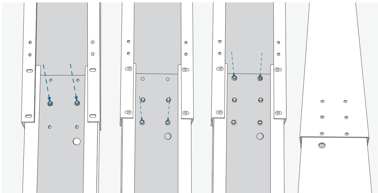
Befestigen Sie von den 6 inneren Schrauben zuerst die mittleren beiden, dann die beiden unteren und zuletzt die beiden oberen Schrauben. Die Muttern sollten nach Innen zeigen und nicht Außen an der Säule befestigt sein.
