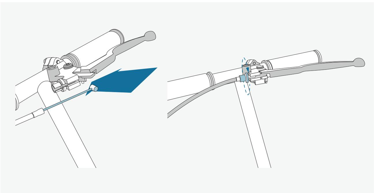
Um den Bautenzug zu befestigen, drehen Sie die Öffnung der Schrauben, um mit der Öffnung vom Griff des Bautenzugs zu gleichen und setzen sie den Bautenzug ein. Anschließend drehen Sie die Öffnung wieder zu.
