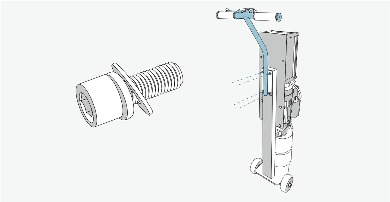
Die Schrauben aus dem Bedienpult schrauben und Seegering sowie Unterlegscheibe wie dargestellt anbringen um damit den Bedienpultgriff anzubringen.
