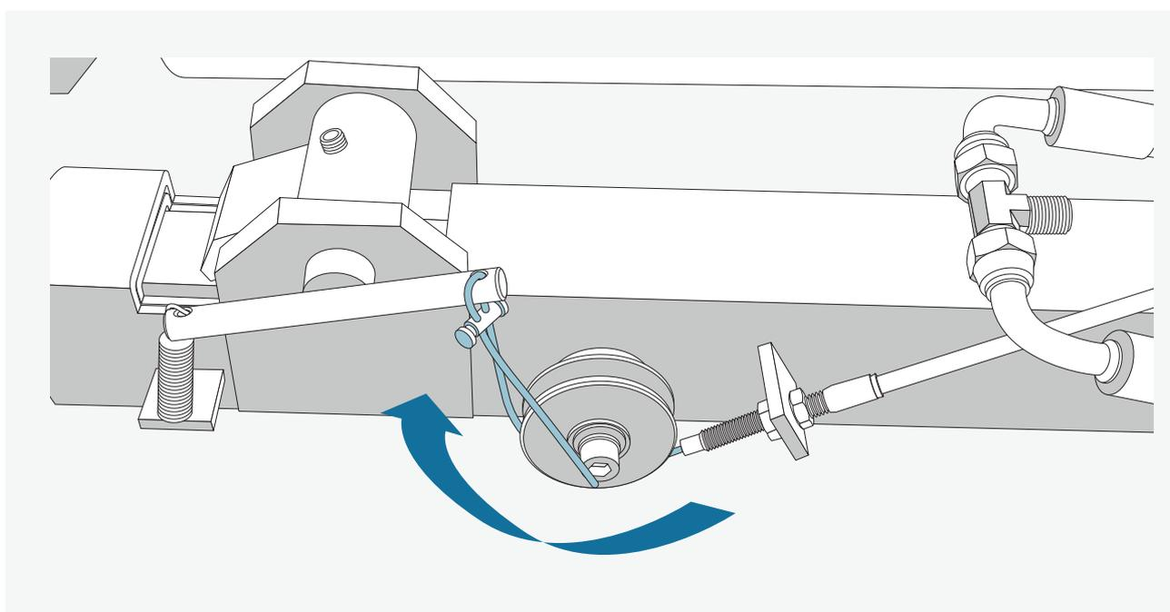
Schrauben Sie die Mutter wieder ran, bevor Sie die den Bautenzug durch den Zug an der Sicherheitsraste führen. Anschließend fixieren Sie den Bautenzug wieder mit der Stellschraube.
