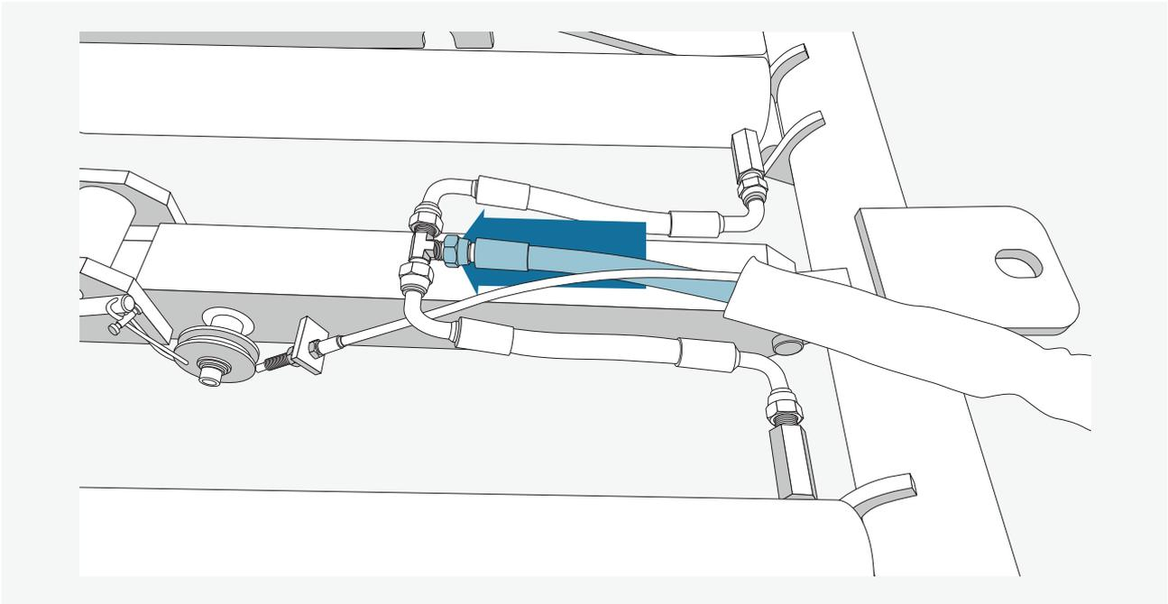
Anschließend schrauben Sie den Hydraulikschlauch an den Hydraulikanschluss der Bühne.
