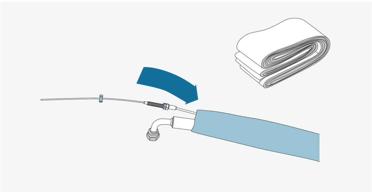
Ziehen Sie den Schlauchschutz über Bautenzug und Hydraulikschlauch, bevor Sie beide mit der Hebebühne verbinden.
