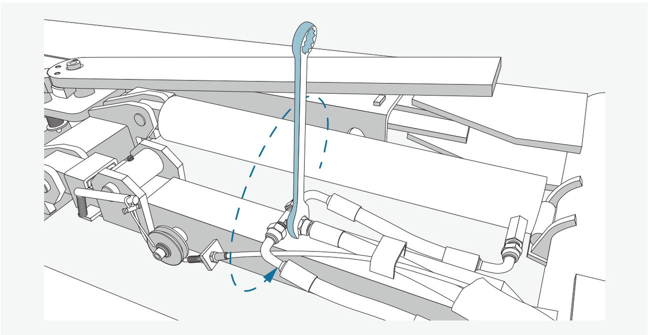
Ziehen Sie den Hydraulikanschluss mit einem Schraubenschlüssel fest.
