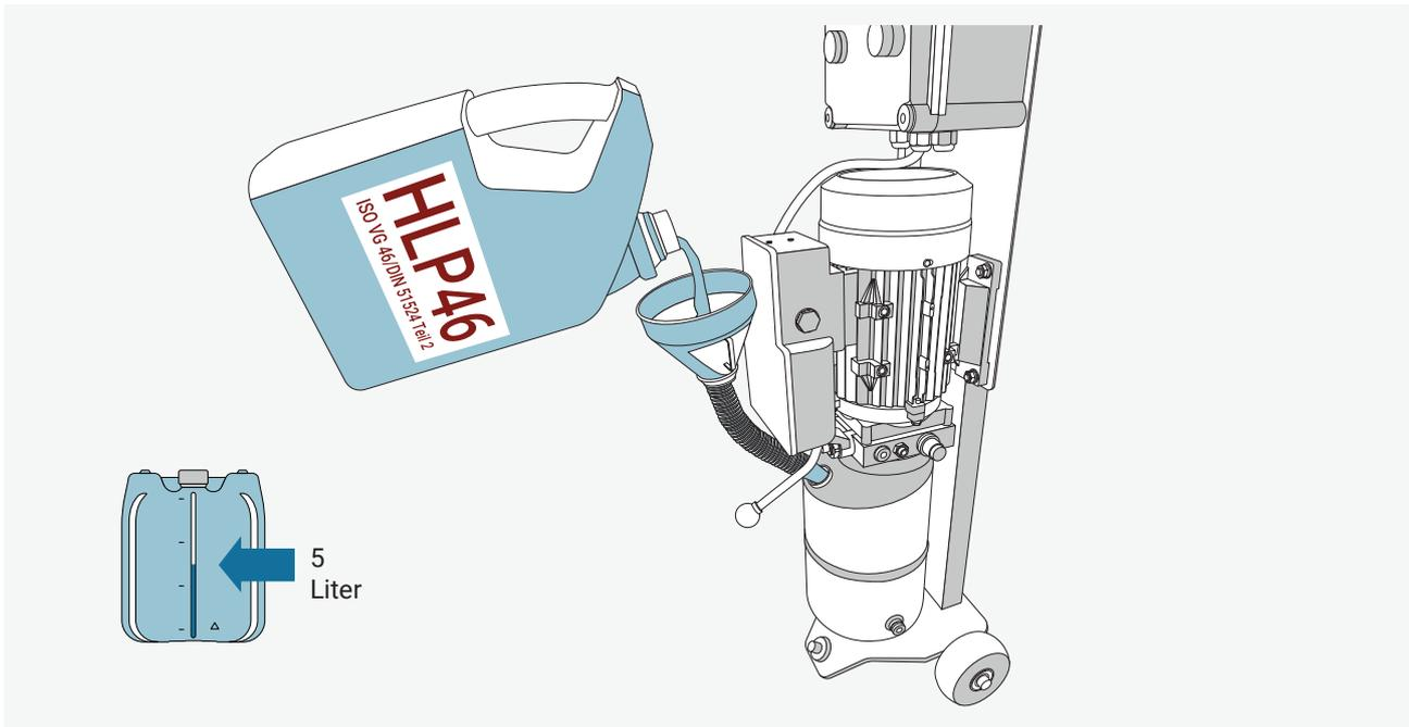
Schrauben Sie den Deckel des Hydrauliktanks auf und füllen Sie das Hydrauliköl, HLP46, in den Tank!
