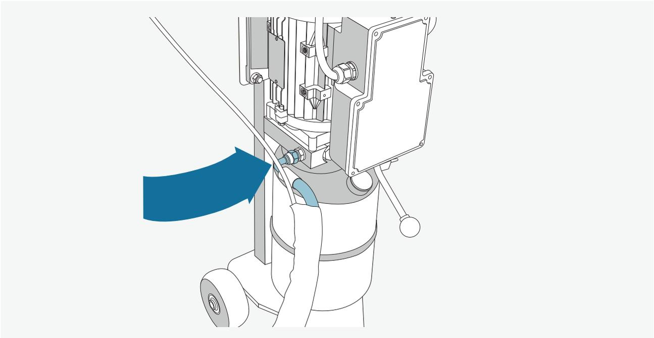
Schrauben Sie das gebogene Ende des Hydraulikschlauches an das Bedienpult.
