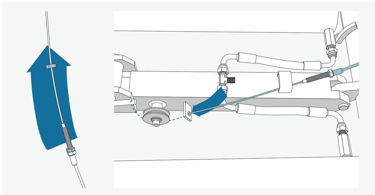
Lösen Sie die Stellschraube und Mutter vom Bautenzug, bevor Sie ihn durch den Kanal in die Laufrolle einsetzen.
