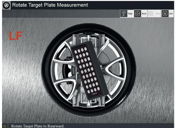
Drehen Sie die entsprechende Zielplatte gemäß den Anweisungen auf dem Bildschirm nach hinten, bis die oberen und unteren Anzeigelampen der Kamera gleichzeitig blinken und auf dem Bildschirm „Stopp“ angezeigt wird. Diesmal hören Sie auf zu drehen, wie abgebildet:
