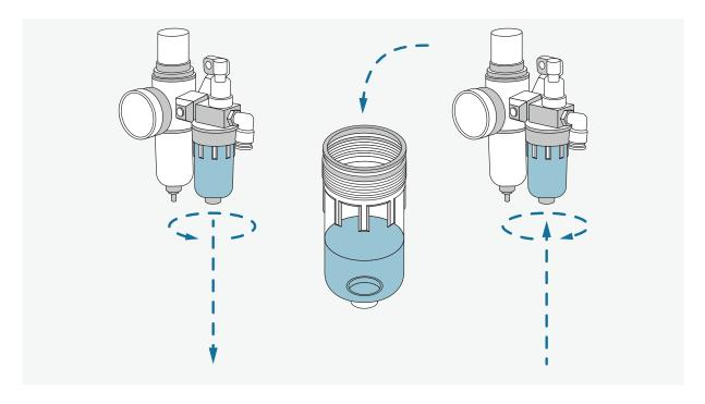
Lösen sie zuvor die rechte Glaskatusche und befüllen Sie sie bis zu zwei Drittel mit Hydrauliköl (HLP-46). Anschließend drehen Sie die Katusche wieder in den Druckluftminderer.
