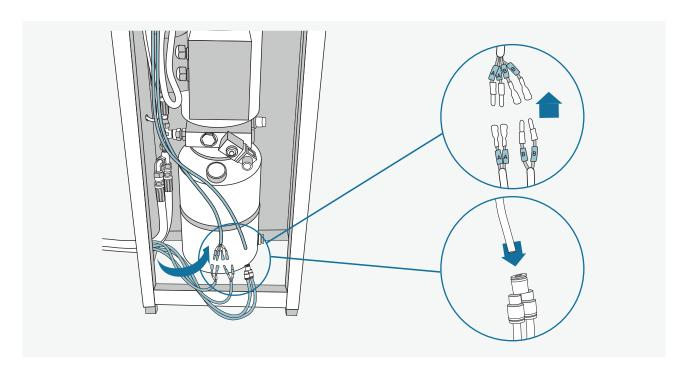
Anschließend werden die (restlichen) Kabel mit dem Bedienpult verbunden (Stecker A zu A; B zu B) sowie der Druckluftschlauch angeschlossen.
