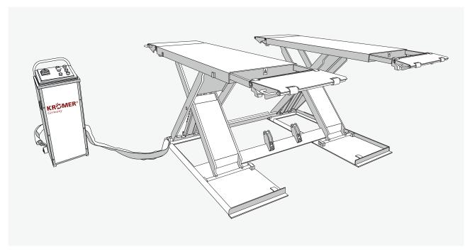
Nach Entfernen des Mobilkits ist die Krömer Scherenhebebühne für Sie einsatzbereit. Hebebühne entlüftet sich selbstständig über den Zylinder. Hebebühne zum Entlüften ein- bis zweimal in unbeladenem Zustand komplett hochfahren.
