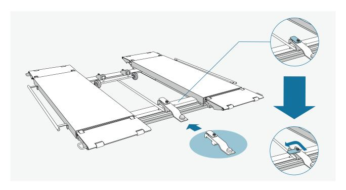
Die Kopplung in die Bühne rasten und Mobilkitgriff durch Umklappen der Sicherung festmachen.
