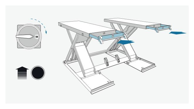
Vier Auffahrampen (e) in die Plattformen schieben doch zuvor die Schrauben an der unteren Seite lösen. Beachten sie die Beschriftung und Richtung der Rampen. Die beiden Vorderen Rampen sind mit einem A gekennzeichnet, sowie die dazugehörige Seite der Plattform.
