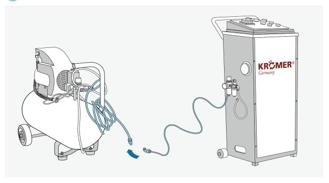
Zusätzlich muss ein Kompressor angeschlossen werden. Dazu den zusammengerollten Druckluftschlauch vom Druckluftminderer an den Kompressor anschließen.
