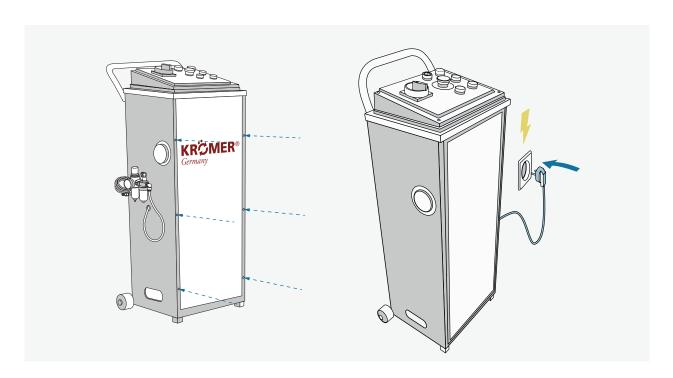
Nach Anschluss der Kabel kann die Vorderseite des Bedienpultes wieder angeschlossen werden und das Bedienpult mit dem Strom angeschlossen werden.
