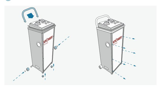
Zunächst die Räder des Bedienpultes sowie den Haltegriff und die Bodenabdeckungen befestigen. Um das Bedienpult mit Hydrauliköl befüllen zu können und die nötige Verkabelung anzuschließen, muss die Vorderseite abgenommen werden.
