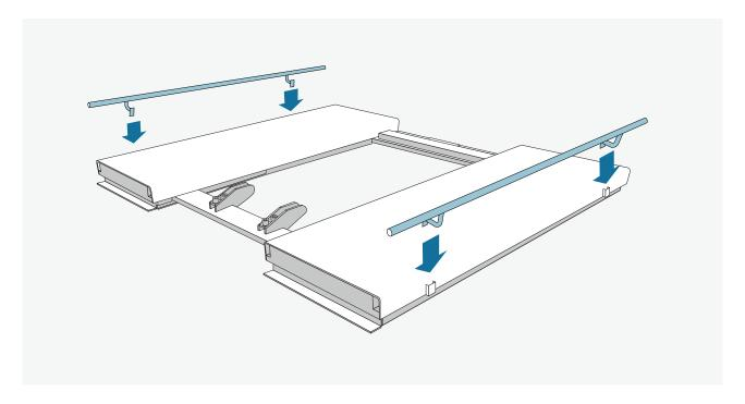
Die Fußschutzstangen (m) werden in die Halterungen einfach eingehangen.
