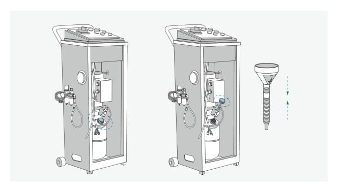
Den Öltank aufschrauben und mithilfe eines Trichters (nicht im Lieferumfang enthalten) kann das Hydrauliköl eingefüllt werden.
