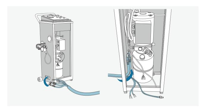
Die von der Hebebühne ausgehenden Kabel durch das Loch in der Seite des Bedienpultes führen und den Hydraulischen Anschluss wie dargestellt mit dem Bedienpult verbinden.
