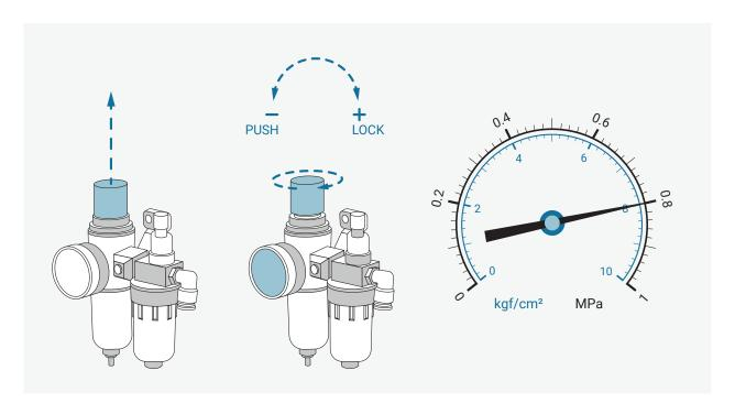
Schalten Sie den Kompressor ein und ziehen sie die obere Schraube des Druckluftminderers nach oben und schrauben sie entgegen des uhrzeigersinns auf. Achten Sie auf den Ausschlag des Druckluftanzeigers. Drücken Sie das Rädchen wieder rein sobald die Anzeige 0.8 MPa oder 8 kgf/cm² zeigt.
