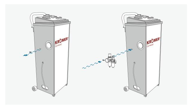
Die beiden Schrauben zur Fixierung aus dem Bedienpult lösen und damit den Druckluftminderer an die Außenseite anschließen.
