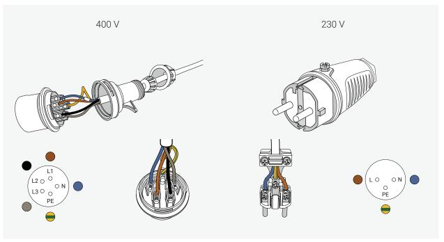
CEE Stecker (f) je nach Bedienpult anschließen.
