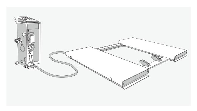
Nach dem Befüllen des Bedienpultes wird die Bühne angeschlossen, dazu müssen die Kabel von der Bühne gelöst werden.
