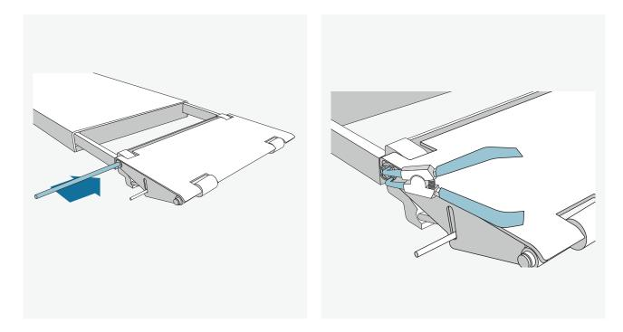
Die Halterungsstange einschieben und anschließend mit einem Sperring sichern.
