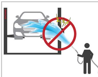
Hebebühne vor Feuchtigkeit schützen und elektrischen Anschlüsse immer trocken halten!
